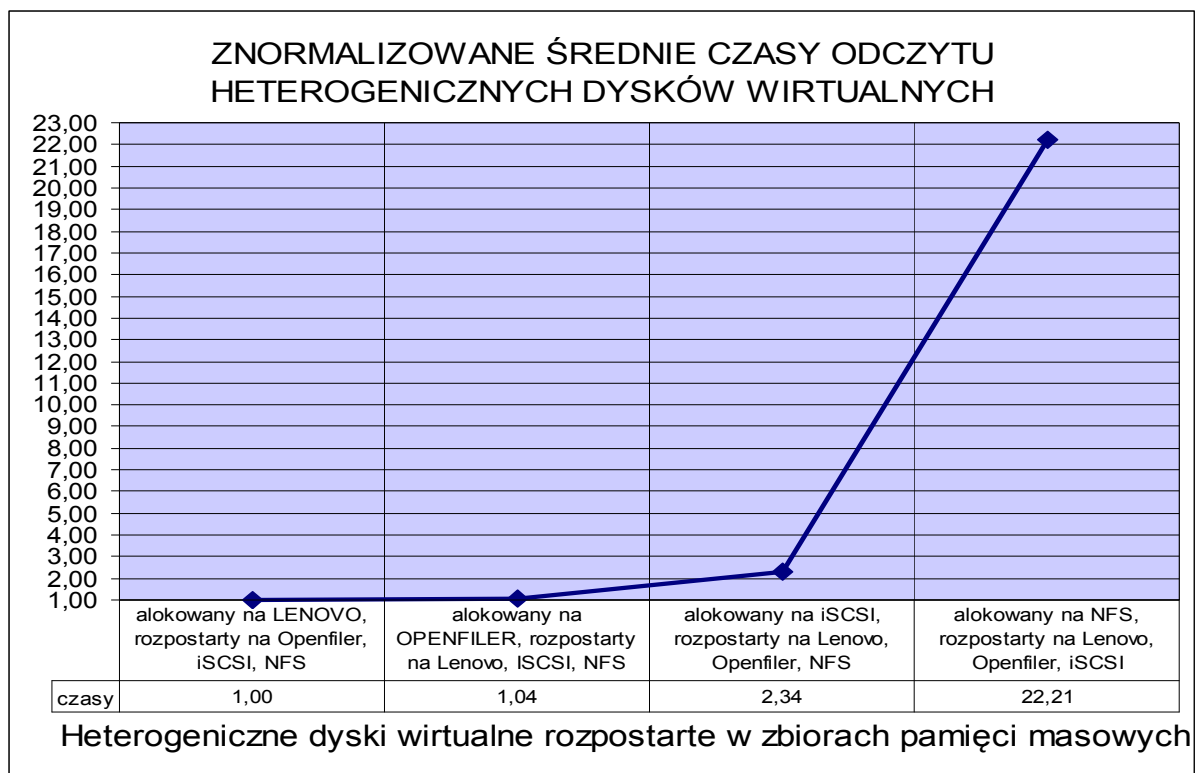
Rys. 8. Znormalizowane średnie czasy odczytu w heterogenicznych dyskach wirtualnych alokowanych w pamięciach masowych
